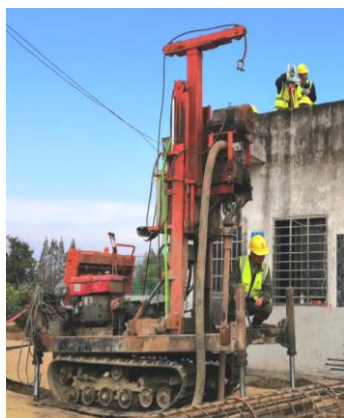
图7 履带式低净空灌注桩机
